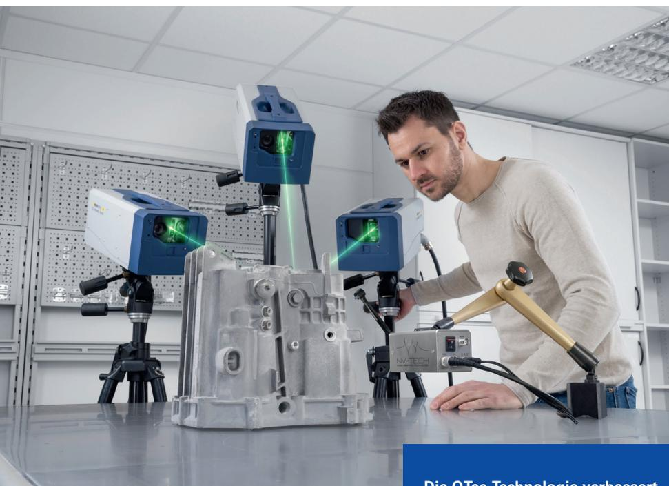
**Die QTec-Technologie verbessert den Signal-Rauschpegel bei Schwingungsmessungen auf technischen Oberflächen signifikant.** © Polytec GmbH
